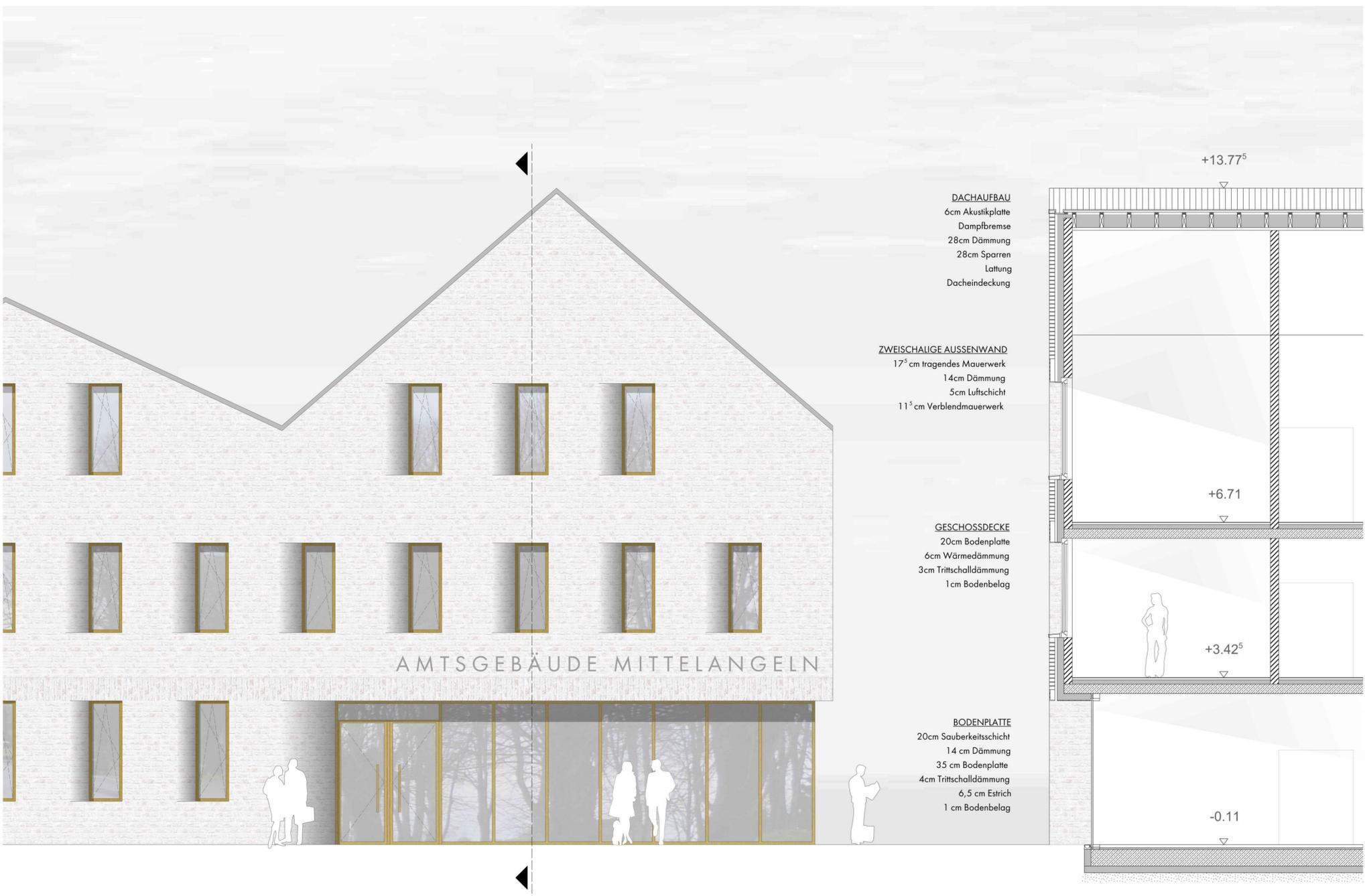
FASSADENDETAILSCHNITT UND -ANSICHT M 1:50
