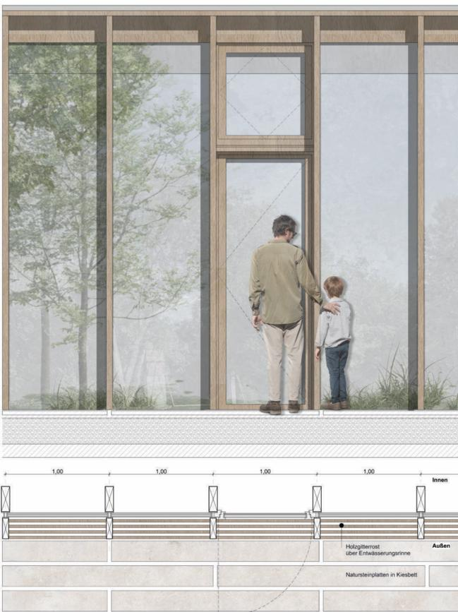
Ansicht Pfosten-Riegel Fassade M1: 20
