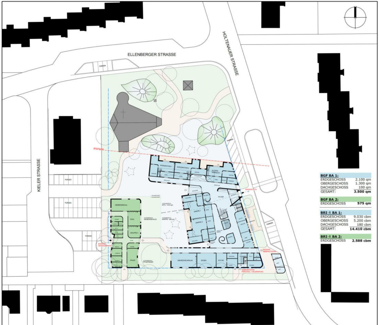
LAGEPLAN: GRUNDRISS ERDGESCHOSS MIT FREIFLÄCHEN | M 1:500
