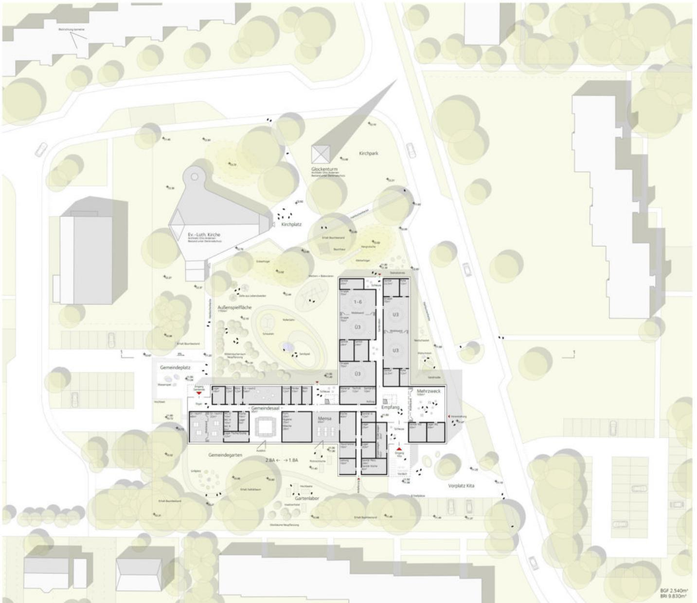
GRUNDRISS ERDGESCHOSS MIT FREIFLÄCHEN 1:500
